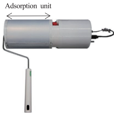
図 11 改良したクリーナー Fig. 11 An improved electrostatic lint roller.
