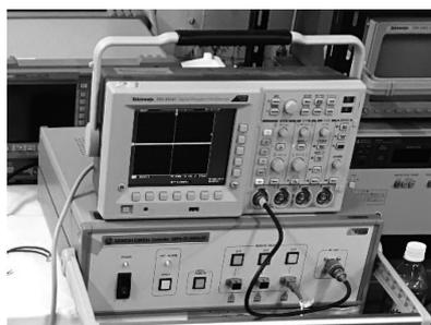
図 14 光電圧プローブコントローラー
