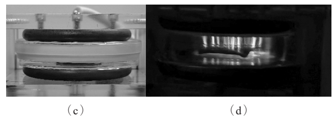
図3 キャベツ片を入れたシャールの様子と電極への設置と放電状況
