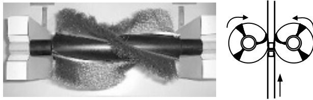
図3 回転ブラシのカットモデルと集塵極エレメントの配置 Fig. 3 Photograph and schematic diagram of the rotating brush and the collecting plate.
