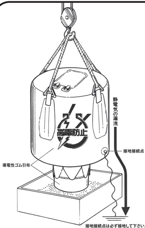
※本体・注入口・つりベルト・排出口に導電性材料を使用し、
